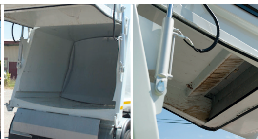
2 Glatte flächige Seitenwände und kielartige Bodengruppe mit seitlichen Führungen für das Ausstoßschild
