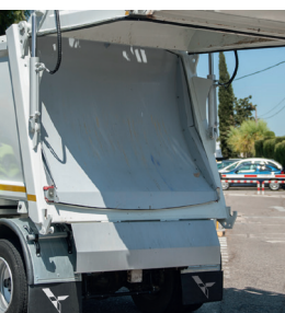
1 An den Aufbau angepasstes Ausstoßschild
