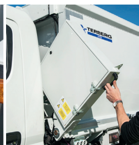
6 Leicht zugängliche Aufbauelektronik
