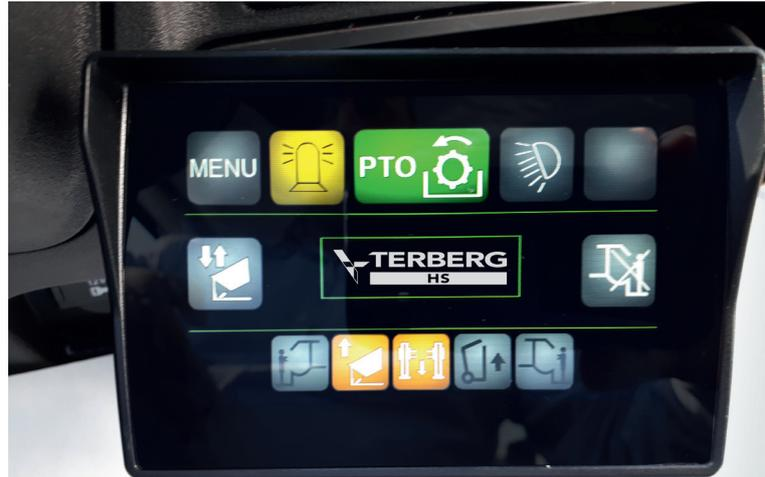
CAN-BUS-System und Bediendisplay im Fahrerhaus
